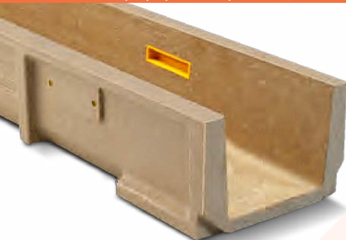
Canal de Hormigón Polímero tipo modelo **HIDROMAX 150**, ancho exterior 204mm, ancho interior 150mm y altura exterior 140mm, para recogida de aguas pluviales, en módulos de 1 ML de longitud, cancela de seguridad y tornillería correspondiente.
